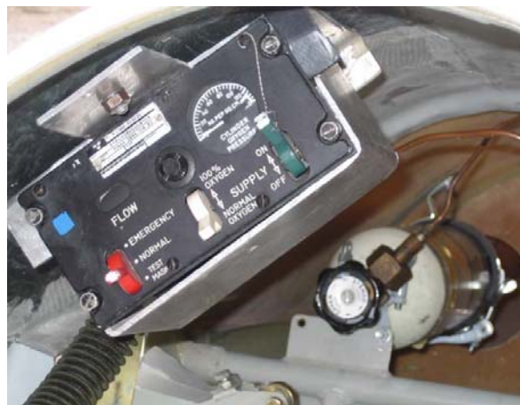
Bild på en Bendix-regulator monterad i en Discus
