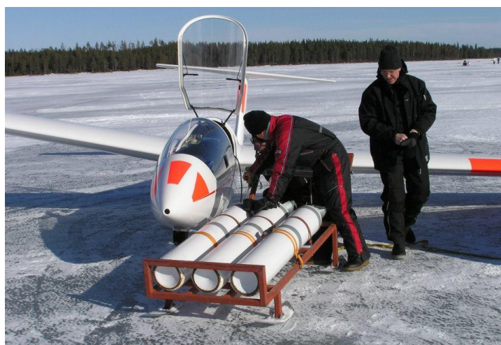
Tankning av syrgas från ”Tubkälken”
